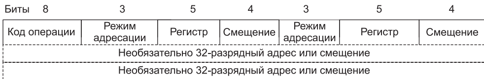
Рис. 5.17. Простые форматы команд для двухадресной машины
