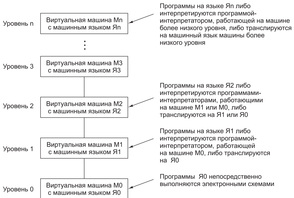
Рис. 1.1. Многоуровневая машина
