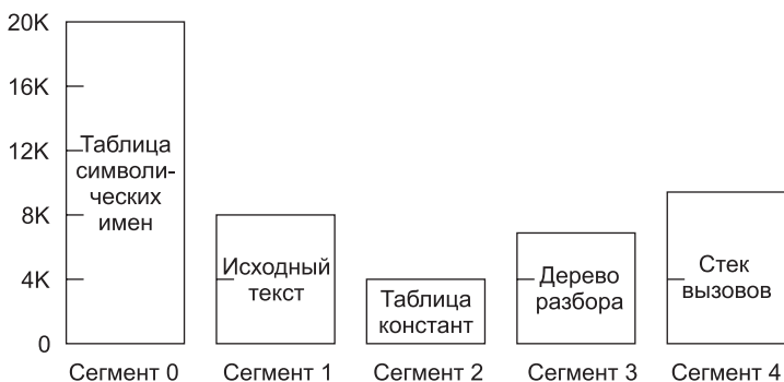
Рис. 6.8. Сегментированная память позволяет менять размер каждой структуры независимо от других
