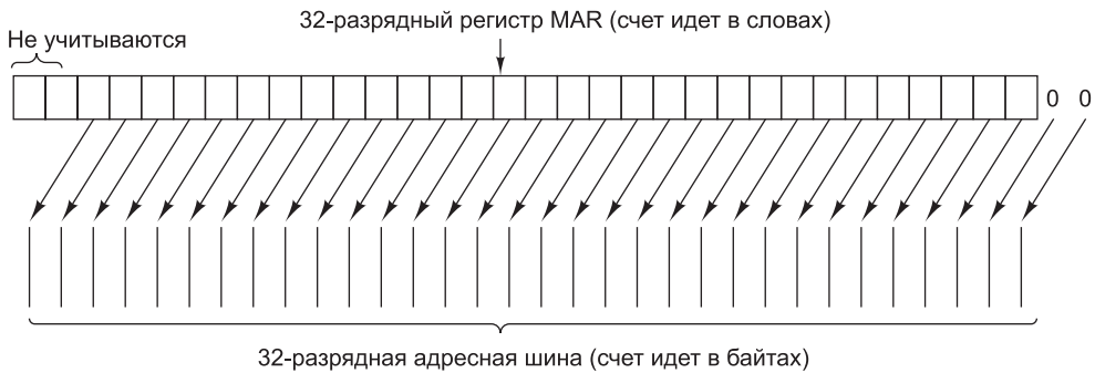
Рис. 4.3. Распределение битов регистра MAR в адресной шине
