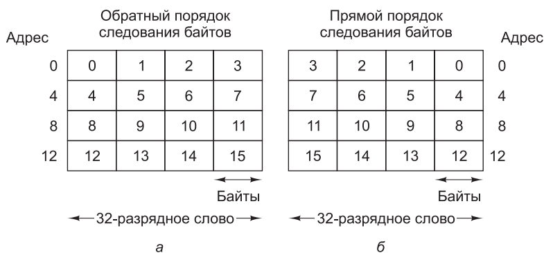
Рис. 2.9. Память с прямым порядком следования байтов ( а ); память с обратным порядком следования байтов ( б )
