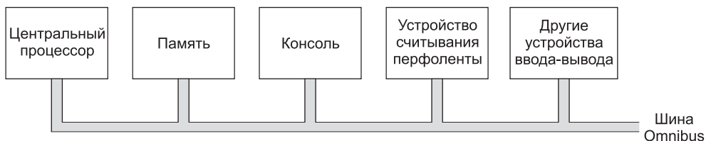
Рис. 1.5. Шина компьютера PDP-8
