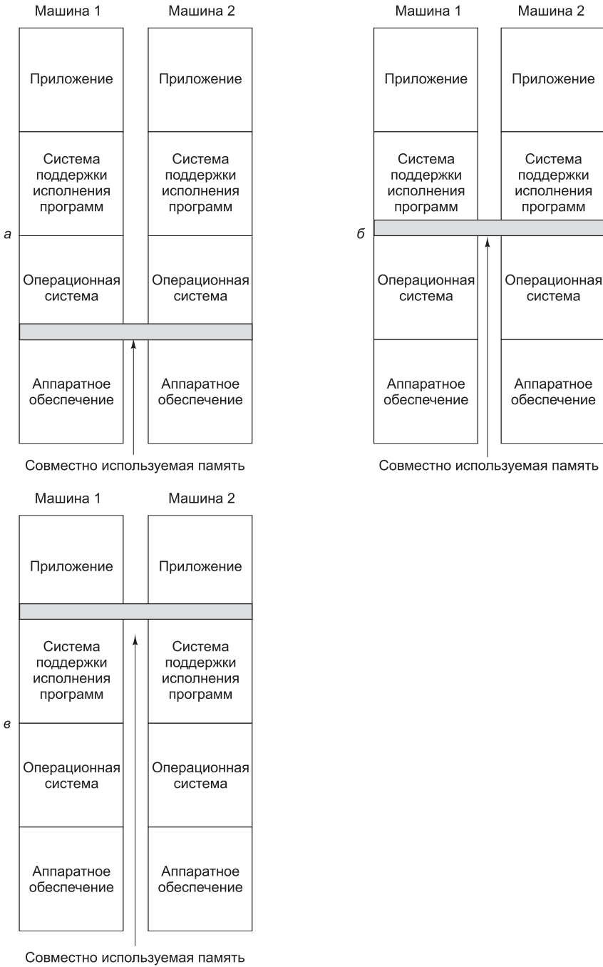
Рис. 8.21. Различные уровни реализации совместно используемой памяти: а — на аппаратном уровне; б — на уровне операционной системы; в — на уровне программного обеспечения пользователя
