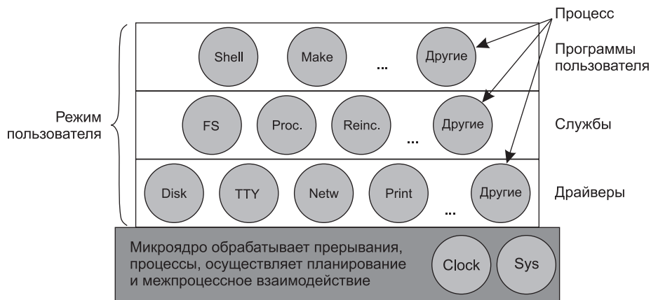
Рис. 1.22. Упрощенная структура системы MINIX 3
