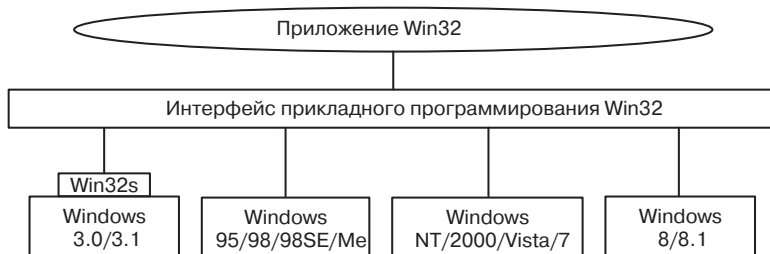
Рис. 11.1. Интерфейс прикладного программирования Win32 позволяет программам работать почти во всех версиях Windows
