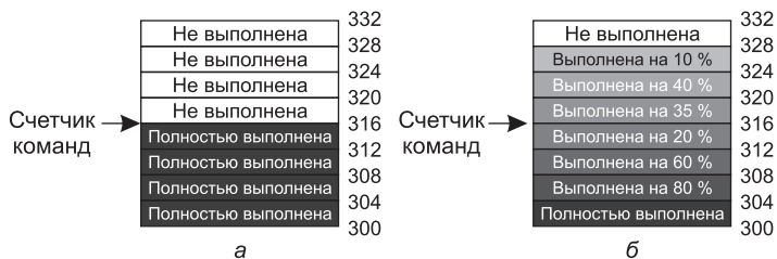
Рис. 5.5. Прерывание: а — точное; б — неточное
