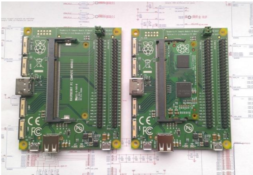
Рис.10.7 Порожня плата IO ліворуч, вставлений комп'ютерний модуль на платі праворуч.
