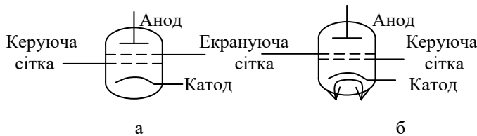
Рис. 2.4.5. Умовні графічні зображення електровакуумного тетрода:
