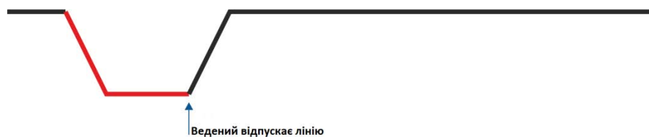
Рисунок 5.4 – Сигнал читання при отриманні 1
