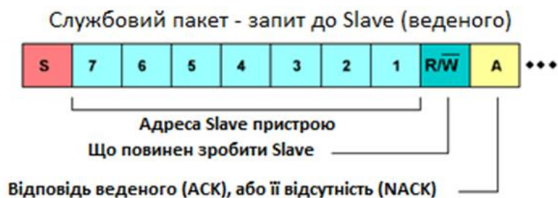
Рисунок 8.3 – Структура кадру обміну через I2C
