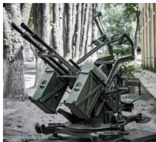
Рис. 5. 14,5-мм спарена зенітна кулеметна установка ЗПУ-2 (56-УС-562) (СРСР) Джерело: [5].
