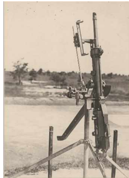
Рис. 2. Перший зенітний приціл на кулеметі “Сен-Етьєн” (1907 рік) Джерело: [2].
