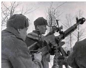
Рис. 18. Загальний вигляд зенітного прицілу 1938 р. на кулеметі ДШК Джерело: [19].
