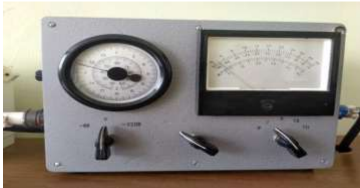
Рис. 1.7 - Вимірювальний пульт ДМС-М-49: 1-показчик температури повітря і швидкості вітру; 2-показчик відносної вологості і напрямку вітру; 3,4,5-ручки управління; 6-кожух; 7-клеми; 8,9-штепсельні роз'єми.
