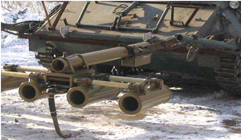
Рис. 1.142 – Індукційний широкозахоплювальний міношукач ШЗМ-А
