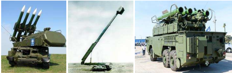
Рис. 1.110 – Елементи ЗРК “Бук-М2” (самохідна вогнева установка, радіолокатор підсвіту та наведення та самохідна вогнева установка на колісному шасі МЗКТ-6922)
