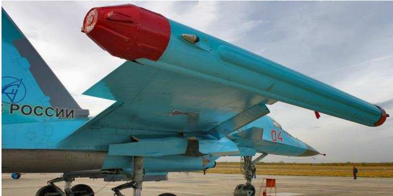
Рис. 2.121 – Комплекс РЕБ “Хибины”
