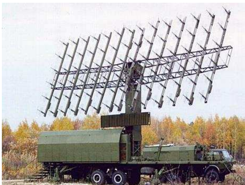
Рис. 2.190 – РЛС “Небо-СВУ” в розгорнутому стані
