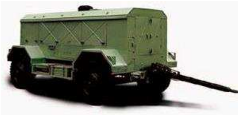
Рис. 2.117 – Зовнішній вигляд уніфікованої компресорної станції УКС-400
