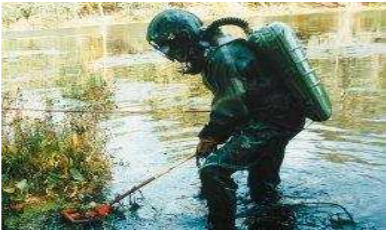
Рис. 1.152 – Зовнішній вигляд водозапливного міношукача МІВ-2
