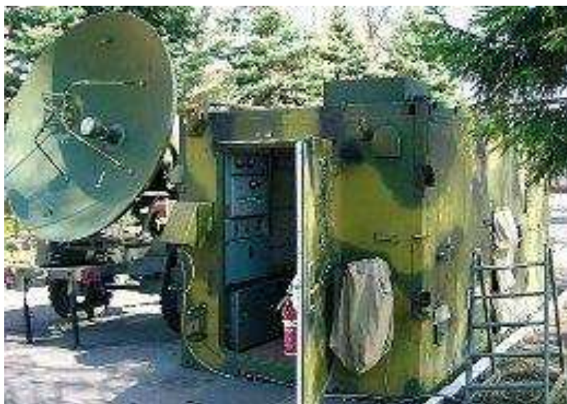
Рис. 1.203 – Станція супутникового зв'язку контейнерна вузлова Р-439-КУЛ
