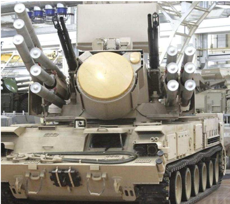
Рис. 2.174 – БМ 72В6Е на шасі ГМ-352М1Е ЗРГК “Панцирь-С1”
