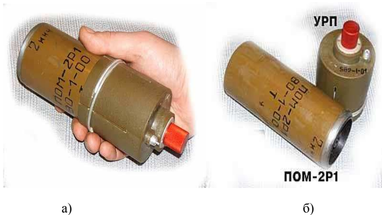
Рис. 1.172 – а) протипіхотна фугасна міна дистанційного мінування натяжної дії ПОМ-2(Р); б) пристрій ручного встановлення УРП
