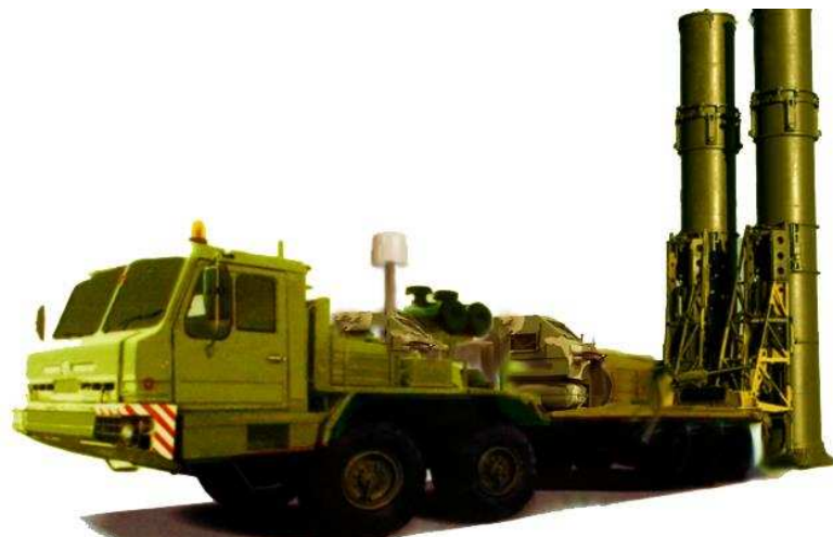
Рис. 2.154 – ПУ 51П6М з ракетами 40Н6М в ТПК
