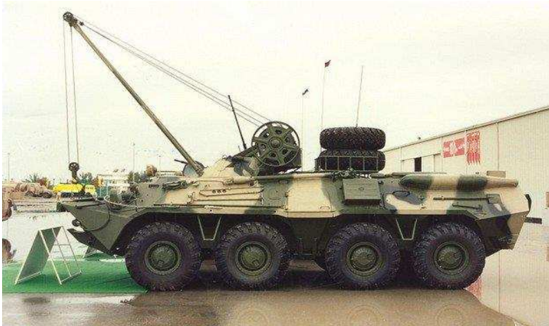
Рис. 1.144 – Броньована ремонтно-евакуаційна машина БРЭМ-К
