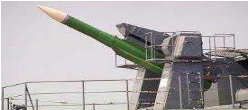
Рис. 3.68 – Пусковий пристрій ЗРК “Ураган” із ракетою 9М38
