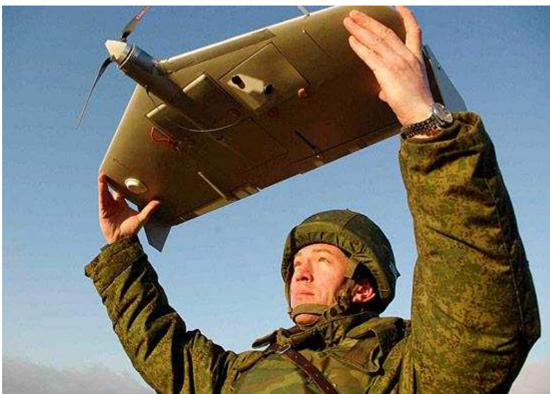
Рис. 1.57 – Безпілотний літальний апарат “Груша” під час запуску
