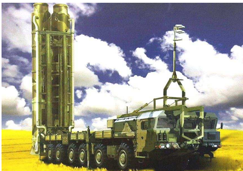
Рис. 2.155 – ПУ 77П6 із протиракетами 77Н6 в ТПК
