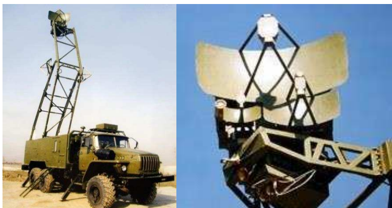
Рис. 6.41 – Мобільна автоматична станція РТР “Орион”
