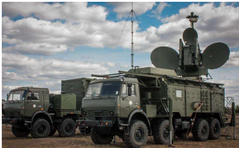
Рис. 6.17 – Станція потужних шумових перешкод 1РЛ257 “Красуха-4”
