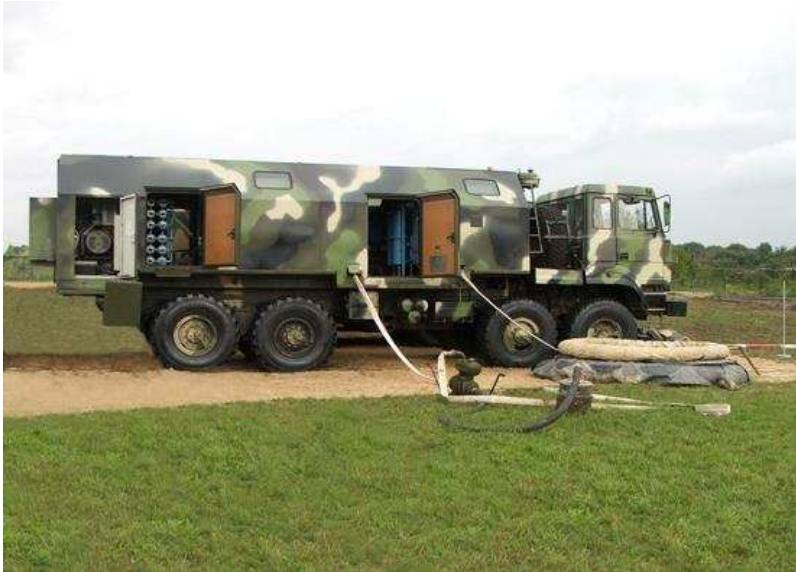
Рис. 1.151 – Станція комплексного очищення й опріснення води СКО-10/5
