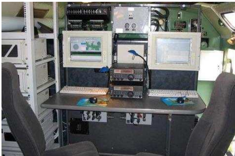
Рис. 6.35 – Робочі місця операторів автоматизованого мобільного комплексу РР “Торн-МДМ”
