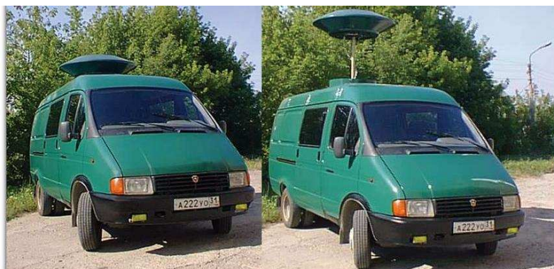
Рис. 6.31 – Автоматизована станція радіотехнічного контролю “Охота”
