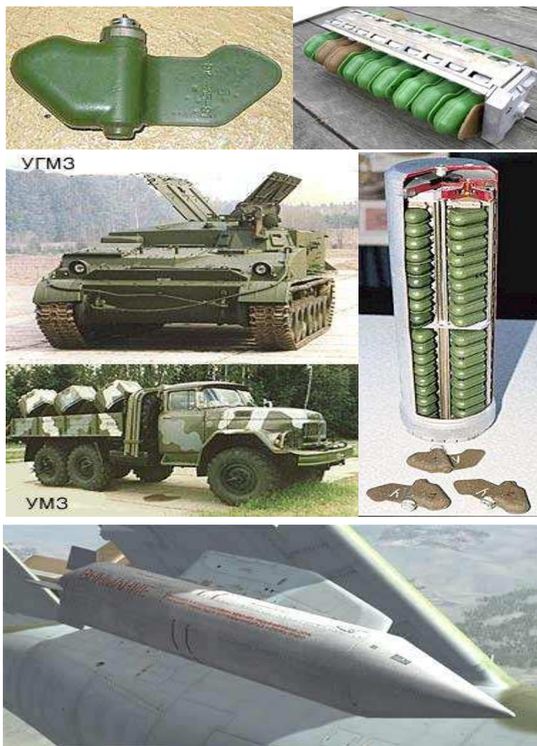
Рис. 1.170 – Протипіхотна фугасна міна дистанційного мінування натискної дії ПФМ-1(С) та засоби її встановлення
