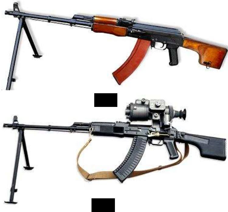
Рис. 7.17 – 5,45-мм ручний кулемет Калашникова: а) – РПК-74; б) – РПК-74М
