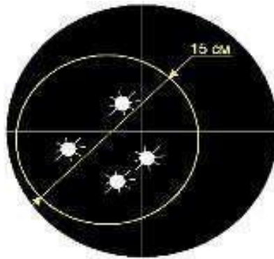
Рисунок 50 – визначення купчастості бою пістолета.
