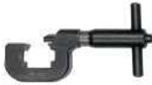
Рисунок 57 – пристосування для зміщення цілика пістолета Макарова.
