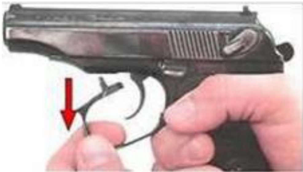
Рисунок 4 – відтягування спускової скоби.
