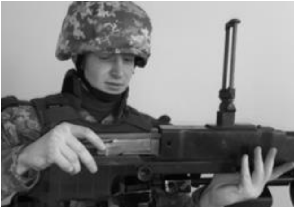
Рисунок 55 – порядок від'єднання рухомої системи
