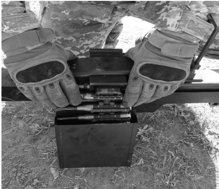
Рисунок 64 – влаштування стрічки в поперечне вікно стрічкоприймача.
