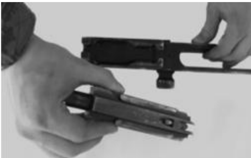
Рисунок 56 – порядок від'єднання затвору з рами.
