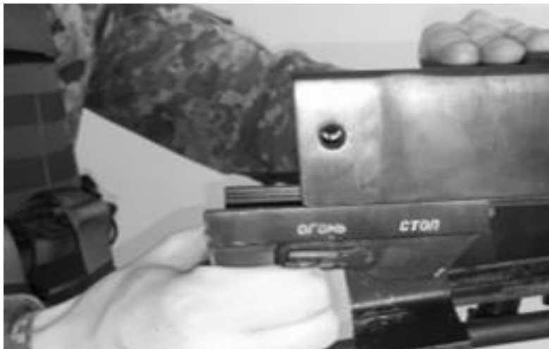
Рисунок 54 – порядок зняття спускової коробки.
