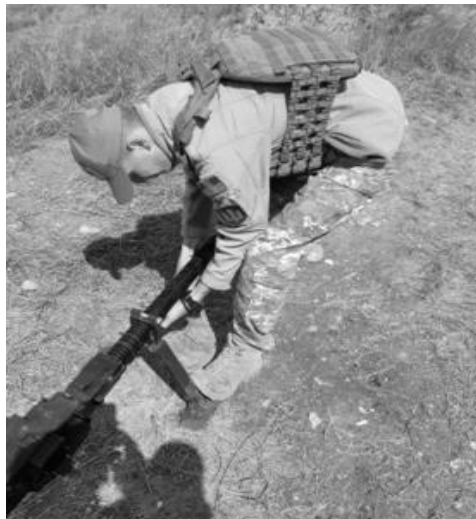
Рисунок 52 – роз'єднання направляючої трубки поршня зі стволом.
