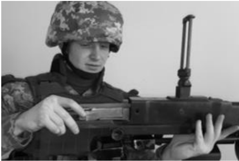
Рисунок 58 – порядок з'єднання затворної рами зі ствольною коробкою.
