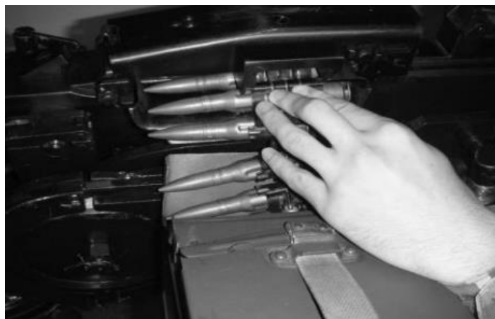
Рисунок 15 – вставляння стрічки в поперечне вікно приймача.
