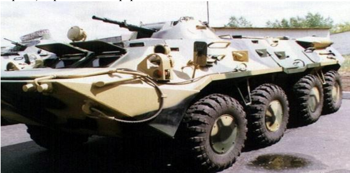
Рисунок 4 – вигляд 14,5-мм кулемета Володимирова (КПВТ) на БТР.
