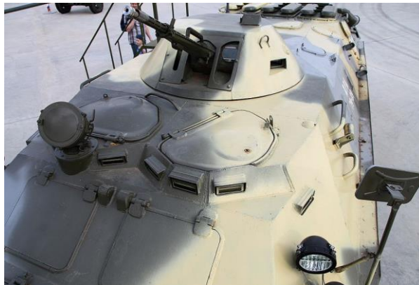
Рисунок 20 – КПВТ на башті бронетранспортера.
