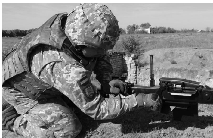
Рисунок 11 – відведення рухомих частин в крайнє заднє положення.
