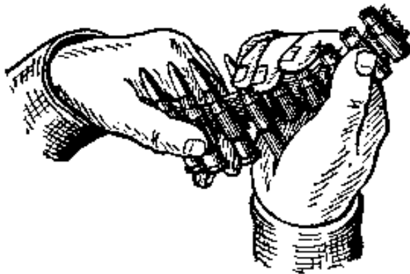
Рисунок 22 – спорядження стрічки вручну.
