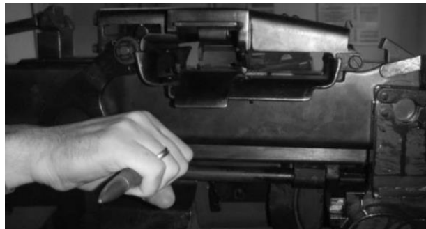
Рисунок 17 – відведення рухомої системи назад за допомогою патрона.
