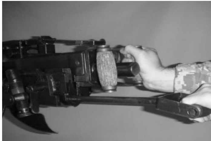
Рисунок 16 – відведення рухомої системи назад за допомогою рукоятки перезарядження.
